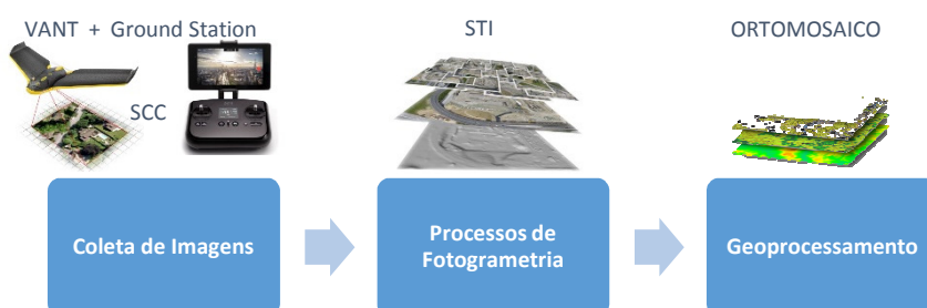
Figura 1: pipeline de geração de informação usando VANTS
